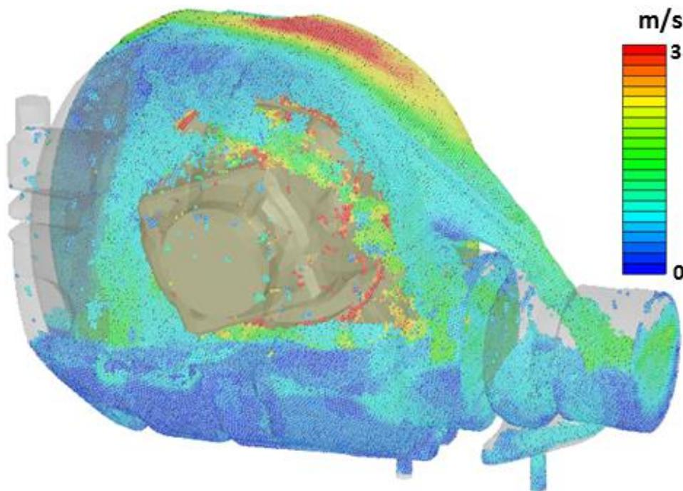
ある瞬間の液流れ。MPS 粒子表示色は MPS 粒子（液）速度の絶対値。
